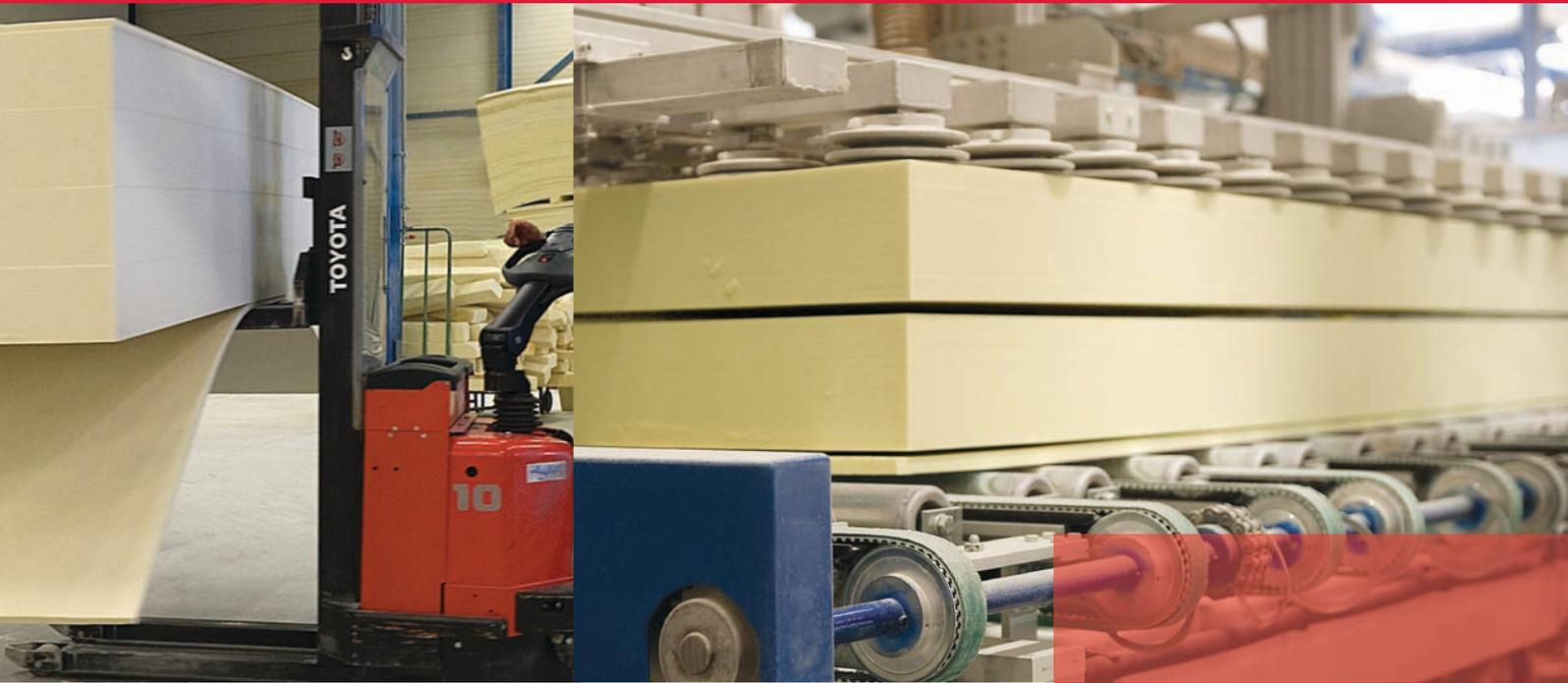
Nous sommes à même de produire du polyuréthane dans une grande variété de dimensions permettant ainsi des applications multiples. L'épaisseur peut varier de 10 à 800 mm. Outre les dimensions standards, nous pouvons également livrer des largeurs et longueurs adaptées aux besoins du client. Les blocs de mousse peuvent par ailleurs être produits en différentes densités, de 30 kg/m<sup>3</sup> à 200 kg/m<sup>3</sup>.
